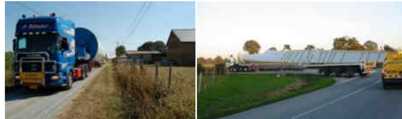
Photo 154 : le transport des éléments d'une éolienne
