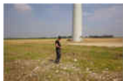
Observateur relié au mât au moyen de la corde marquée tous les 5 mètres. ©Écosphère
