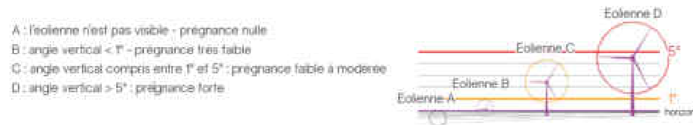
Figure 90 : Principe de l'évolution de la prégnance selon l'angle vertical
